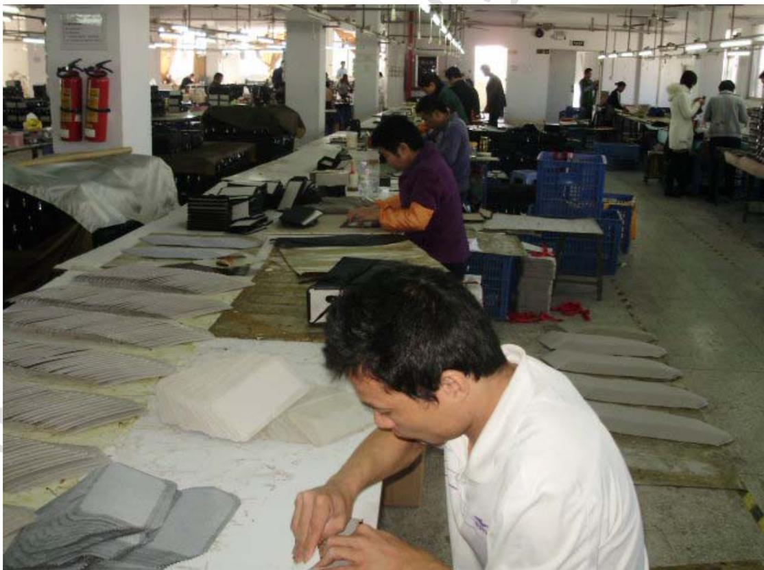
说明：该工作场景为“盒子”的流水线生产车间，每个工人仅完成盒子生产中的一道工序，最前面这位工人正在进行盒子盖面的“刷胶水”工序
